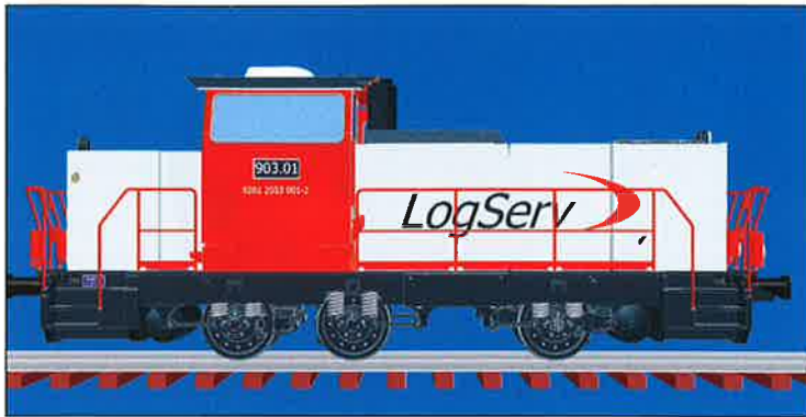
Abb. 2: Entwurf der neuen D60 C mit MTU-Motor 12V1600R50 (690 kW bei 1900/min, Emissionsstufe IIIB).
