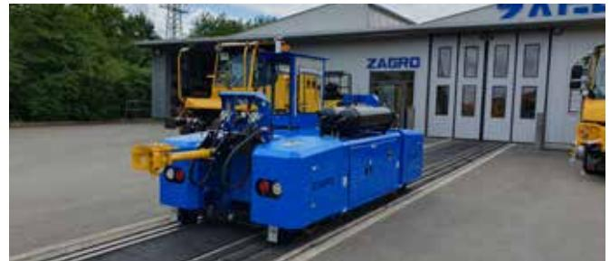
Zusätzlich ist das Fahrzeug gemäß § 32 der EBO-Zulassung zugelassen, was die rechtskonforme Inbetriebnahme durch den Betreiber sichert und die Betriebssicherheit auf höchstem Niveau hält. Die Implementierung von RFID-basierten Stoppensoren ermöglicht eine automatische Sicherheitsabschaltung bei Überschreiten definiert erlaubter Bereiche.
