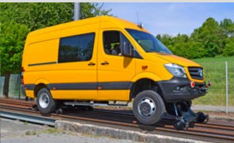
Servicefahrzeug mit Schweißausrüstung Service vehicle with welding equipment
