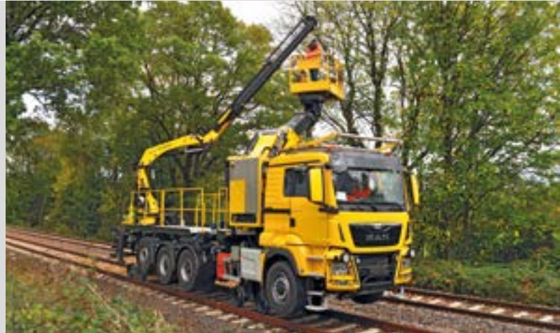
Oberleitungsmontagefahrzeug mit Kran und Arbeitskorb Overhead maintenance vehicle with crane and work basket
