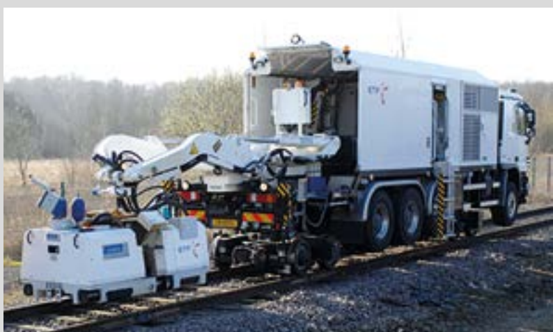
Schienenschweißfahrzeug Rail welding vehicle
