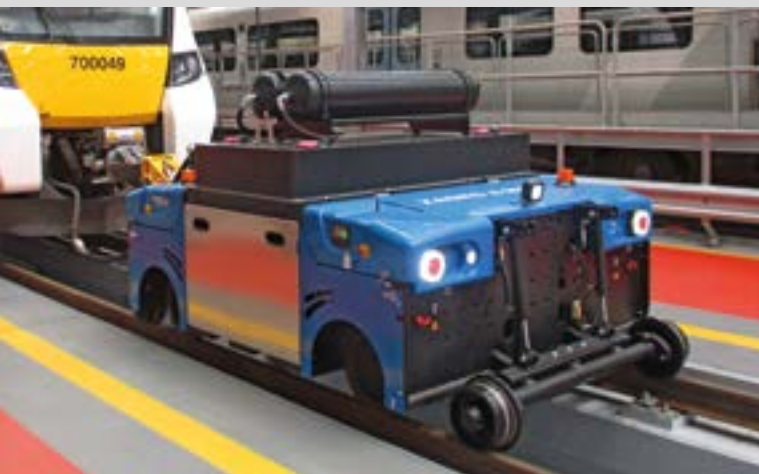
ZAGRO E-MAXI XL mit Waggonbremsanlage ZAGRO E-MAXI XL with wagon brake system
