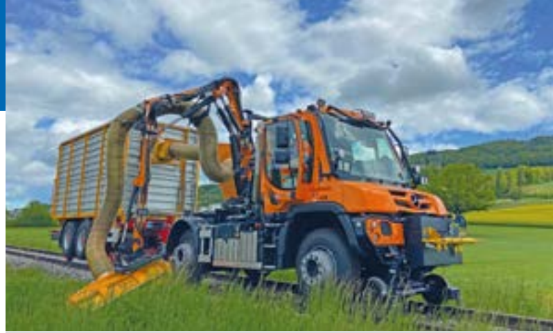
Unimog U 430 mit Mähgerät und Zweibegeanhänger Unimog U 430 with mower and road-rail trailer
