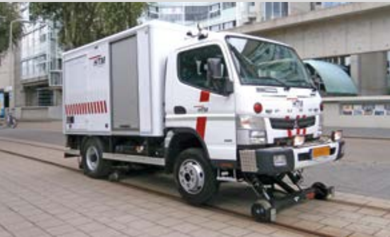
Fuso Canter mit Aufgleisrüstung Fuso Canter with rerail equipment
