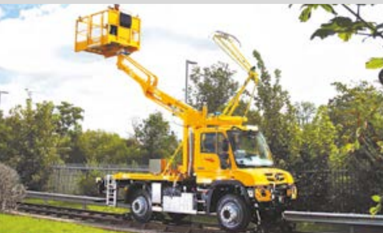
Unimog U 423 Oberleitungsmontagefahrzeug unabgestützt verfahrbar Unimog U 423 overhead line installation vehicle unsupported movement
