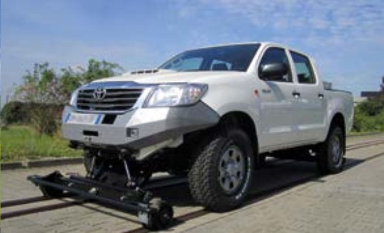
Pick-up mit Schienenführung Pick-up with track guiding system
