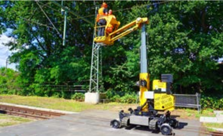
Oberleitungsmontagefahrzeug CATLAD L Overhead maintenance vehicle CATLAD L
