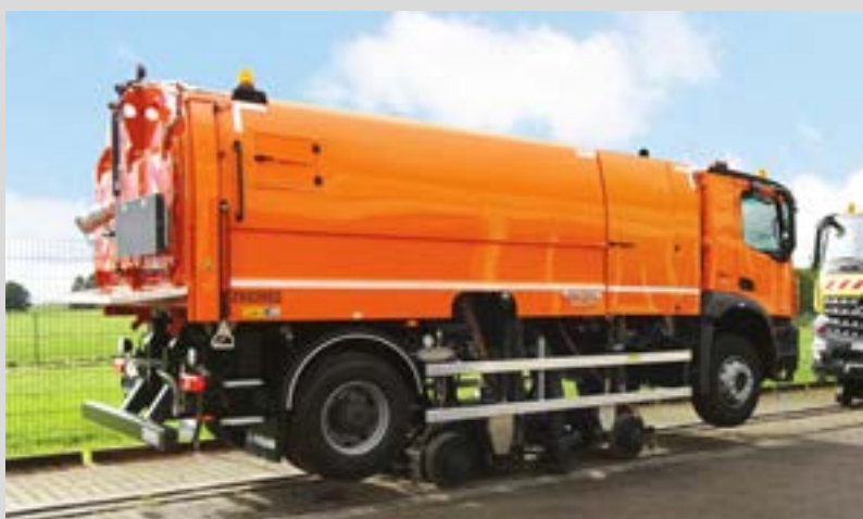
Rillenreinigungsfahrzeug mit Lore-Schienenführung Grooved rail cleaning vehicle with Lore-rail guide
