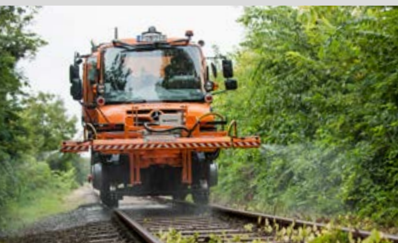
Unimog U 423 mit Spritzeinrichtung zur Vegetationskontrolle Unimog U 423 with spraying equipment for vegetation control
