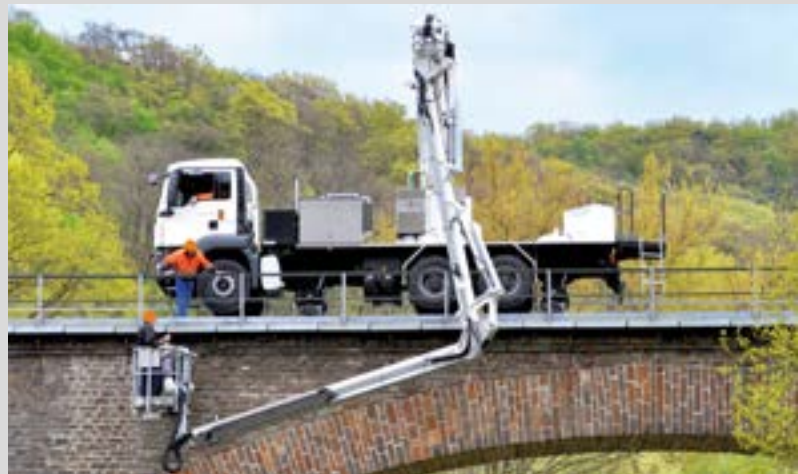
Brückeninspektionsfahrzeug Bridge inspection vehicle
