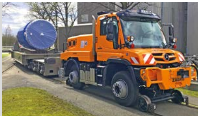
Unimog U 423 Rangierfahrzeug, Laufräder Ø 400 mm Unimog U 423 shunting vehicle, rail wheels Ø 400 mm
