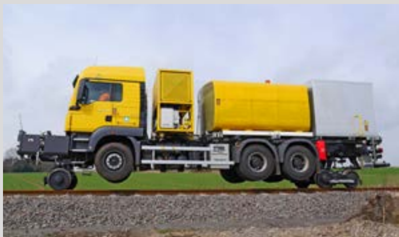
Gleispflegefahrzeug mit Tanks Track maintenance vehicle with tanks
