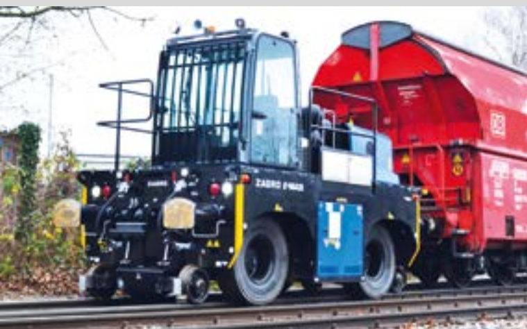
ZAGRO E-MAXI XXL mit 2000 t Waggonbremsanlage und Kabine ZAGRO E-MAXI XXL with 2000 t wagon brake system and cabin
