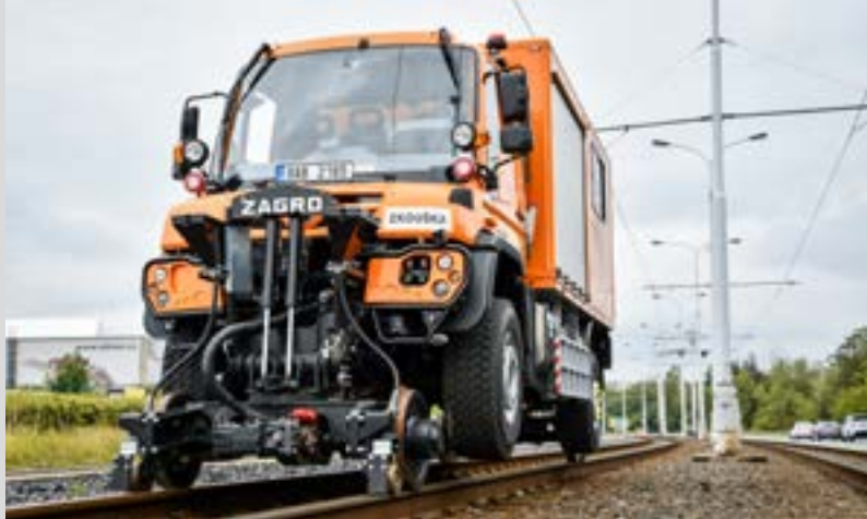
Unimog U 527 mit hydrostatischer Schienenfahreinrichtung Unimog U 527 with hydrostatic rail driving device
