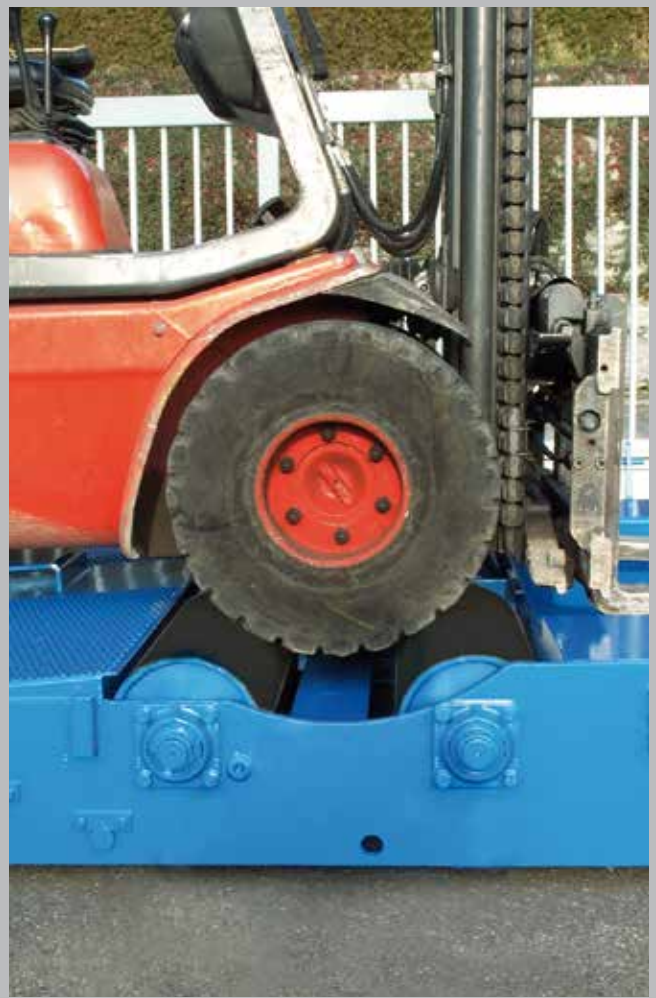
Antriebsrollen zur Kraftübertragung
