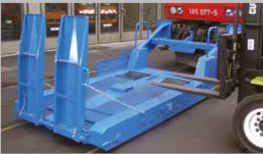
Absetzen auf der Schiene im niveaubenen Bereich
