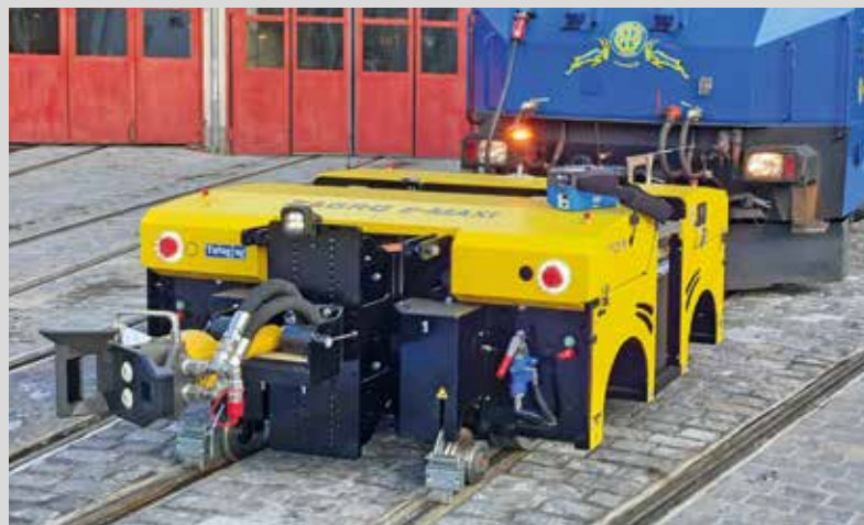
ZAGRO E-MAXI M mit 1000 mm Schmalspur ZAGRO E-MAXI M with 1000 mm narrow gauge
