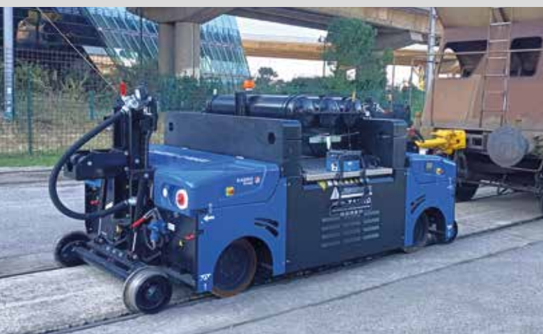
ZAGRO E-MAXI XL VARIO mit Waggonbremsanlage ZAGRO E-MAXI XL VARIO with wagon brake system
