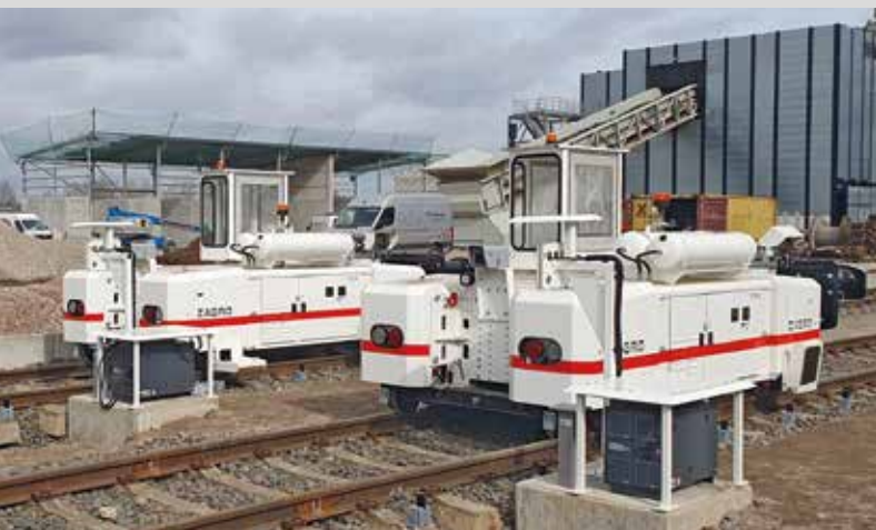
ZAGRO E-MAXI XL – autonomes Rangieren ZAGRO E-MAXI XL – autonomous manoeuvring
