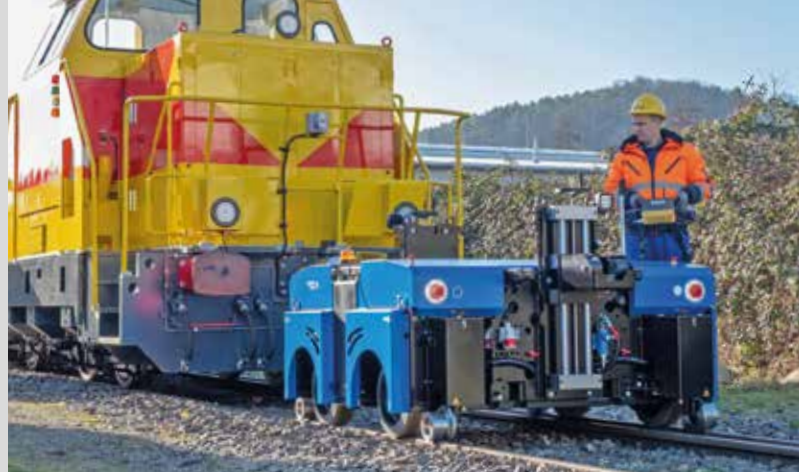
ZAGRO E-MAXI M mit höhenverstellbarer Kupplungsaufnahme ZAGRO E-MAXI M with height adjustable coupler receiver
