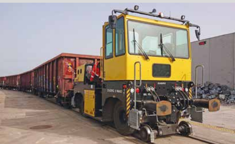
ZAGRO E-MAXI XXL mit langem Radstand ZAGRO E-MAXI XXL with long wheelbase
