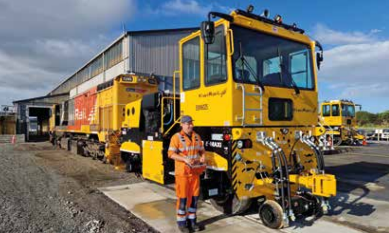
ZAGRO E-MAXI XXL mit 1067 mm Schmalspur ZAGRO E-MAXI XXL with 1067 mm narrow gauge
