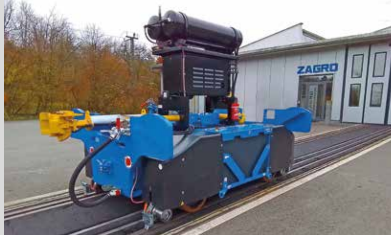
ZAGRO E-MAXI L mit Pufferanlage ZAGRO E-MAXI L with buffers
