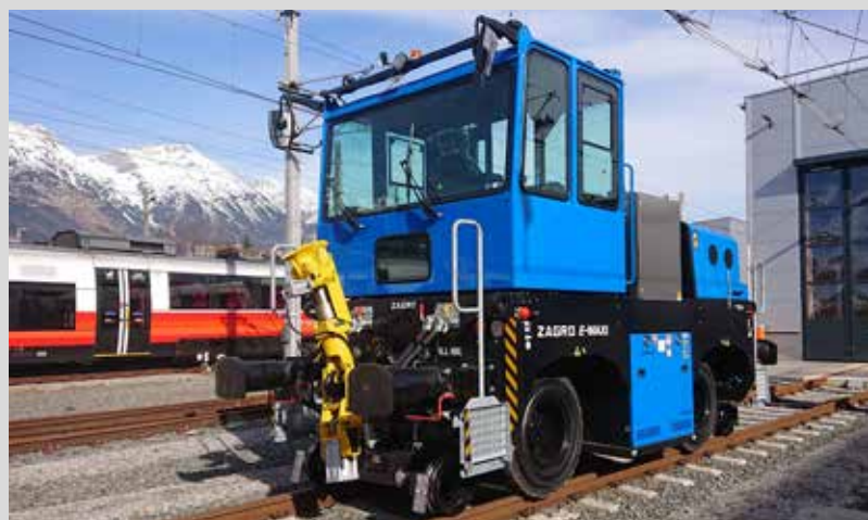
ZAGRO E-MAXI XXL mit kurzem Radstand ZAGRO E-MAXI XXL with short wheelbase
