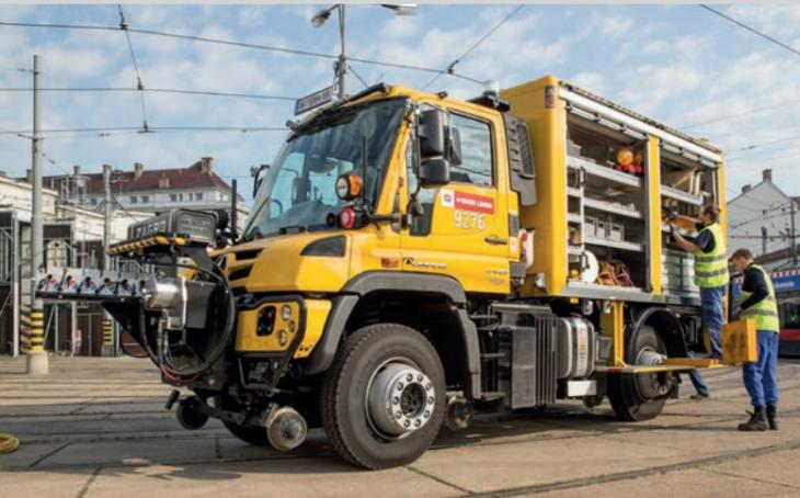
Unimog U 423 Hilfszug mit Drehschemel-Schienenführung
