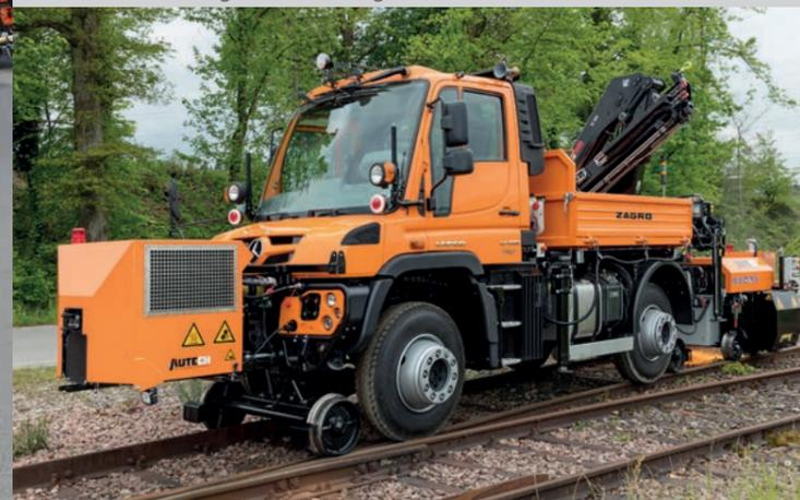
Unimog U 423 Arbeitsfahrzeug mit Schienenschleifeinheit
