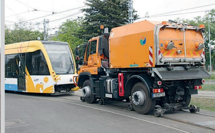
Unimog U 423 Gleisreinigungsfahrzeug
