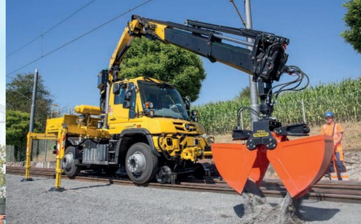
Unimog U 423 Arbeitsfahrzeug mit Zweischalengreifer
