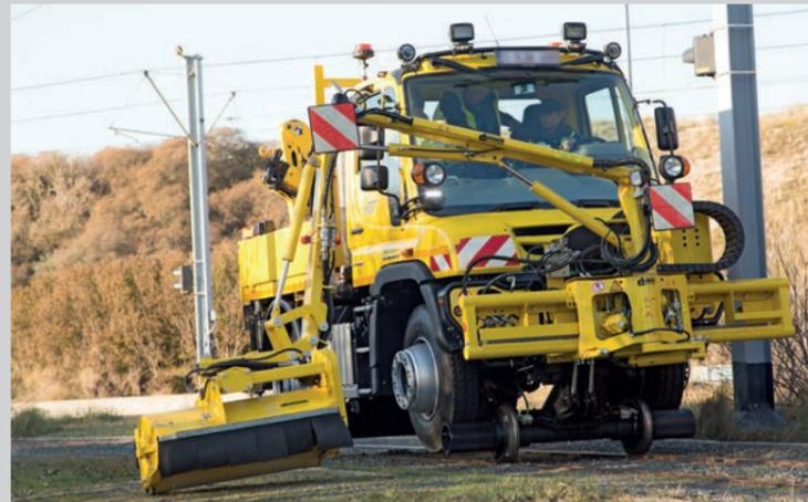
Unimog U 430 Arbeitsfahrzeug mit Reibrad-Schienenführung
