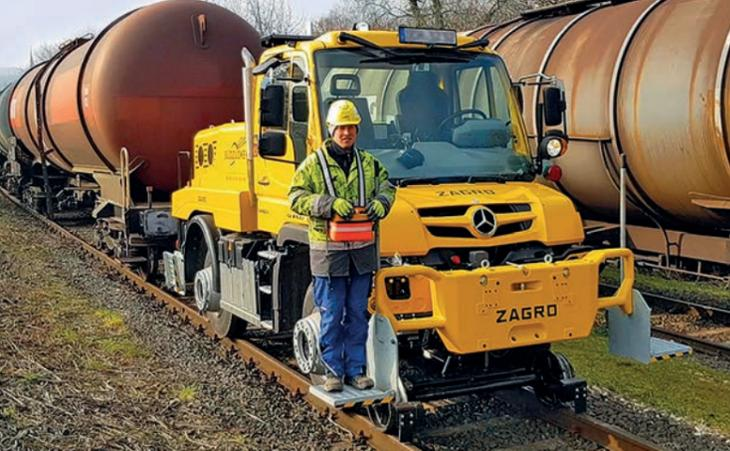
Unimog U 423 Funkrangierer, Lauffräder Ø 400 mm
