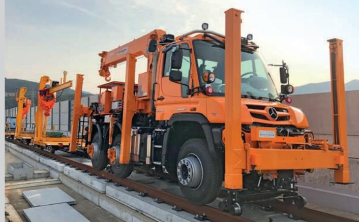
Unimog U 423 Arbeitsfahrzeug, Gelenkrollen Ø 136 mm
