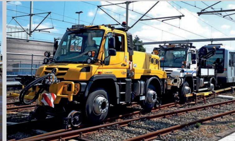
Unimog U 423 im Tandembetrieb zur Traktionserhöhung
